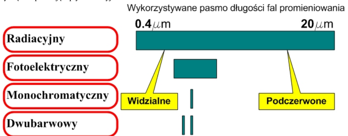
Rys. 4. Obszary promieniowania temperaturowego wykorzystywane w pomiarach pirometrycznych
